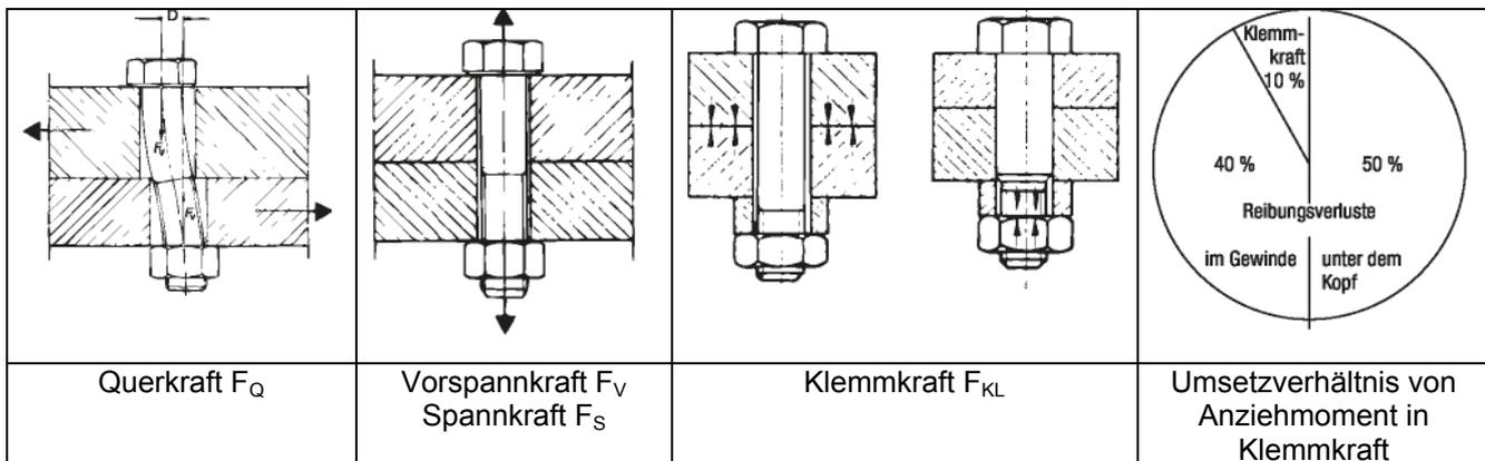
Die jeweils erforderliche Klemmwirkung wird bei der Montage durch Einbringen einer dem Durchmesser und der Streckgrenze des Verbindungselementes entsprechenden Vorspannung  $F_V$  (= vor Betriebsbeanspruchung) über das Anziehen der Gewindeteile erreicht.
